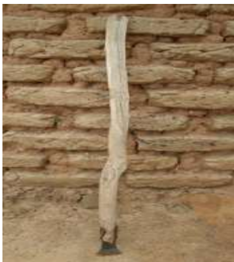
Figure 21: Outil confectionné pour le creusement des trous, source : auteur
