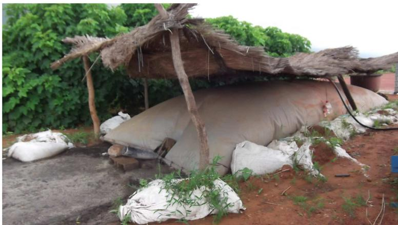
*Unité expérimentale de Malibiocarburant pour le test de la production de biogaz à partir de tourteaux de Jatropha et déjections bovines*
