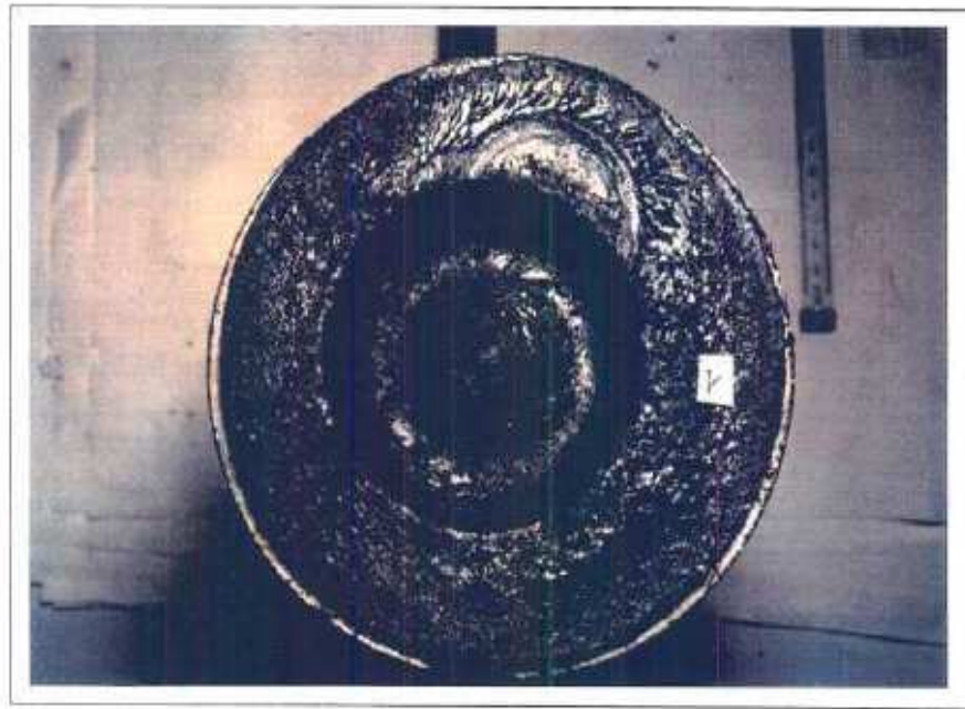
Figure 10 - encrassement typique dû aux huiles végétales (piston de moteur à injection directe, 10 heures de ralenti à vide, huile de tournesol raffinée)
